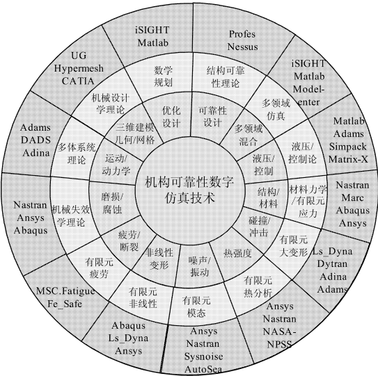
图 3 机构可靠性数字仿真技术和软件工具 Fig. 3 Computer simulation of mechanism reliability
