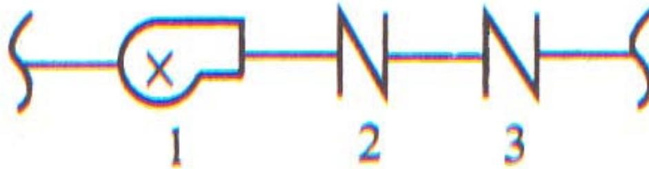
图 2—3 一个泵和两个阀串联的功能系统图
